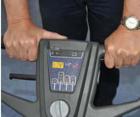
6. Paina yhtä aikaa ohjaukshangan turva- ja käynnistys/pysäytys-kytkimistä harjan kiinnittämiseksi ja vapauta vivut.
