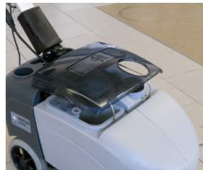
18. Pysäköi kone ja jätä säiliön kansi raolleen.
