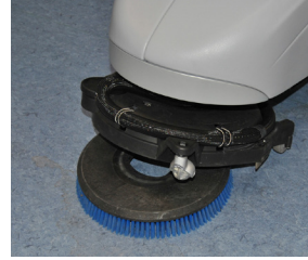
4. Aseta harja tai vetoalusta harjaysikköön. Käytä oikeanlaisista vaihtoehtoja lattian puhdistamiseen.
