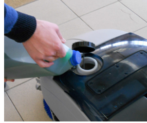
3. Noudata aina pesuaineen laimennusohjeita. Liuksen lämpötila ei saa ylittää 40 °C:tta, eikä se saa vaahdota.
