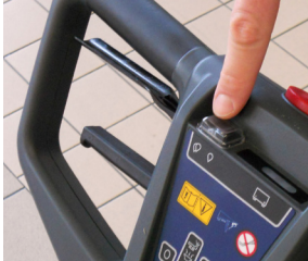
7. Säädä virtauskytkimestä painamalla haluttu pesuliukosen virtauksen määrä.
