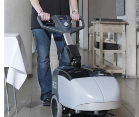
8. Paina yhtä aikaa ohjaukshangan turva- ja käynnistys/pysäytys-kytkimistä aloittaaksesi puhdistuksen.
