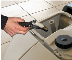
11. Puhdista likavesisäiliö puhtaalla vedellä.
