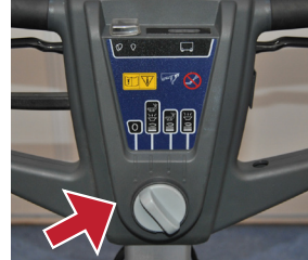
9. Käännä nappi 0-asentoon pysäyttääksesi koneen.
